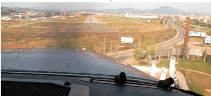
De nuevo, velocidad a 90, flaps 10°, mezcla y alineados. 70 nudos, flaps 20°, eje de pista, pie de derecho y toma en el primer tercio.
